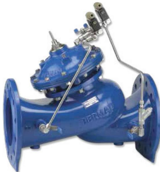
Modell 718-03 elektronisk kontrollventil kombinerer fordelen ved en modulerende, ledningstrykksdrevet, hydraulisk kontrollventil med fordelen ved elektronisk kontroll. Denne ventilen reagerer på signaler fra den elektroniske kontrolleren BERMAD BE (valgfri), ved å endre sin åpnestilling i henhold til settverdiene som er programmert inn i kontrolleren.
