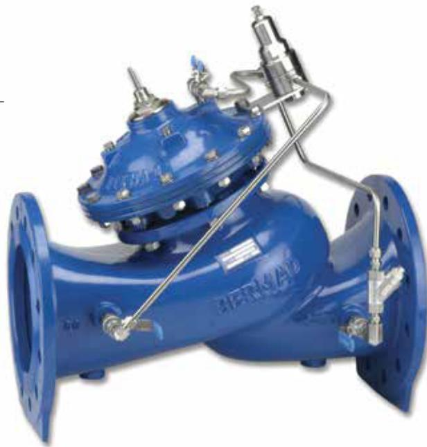
Modell 730 sikkerhetsventil for trykkoppretholdelse er en hydraulisk drevet og membranaktivert kontrollventil som kan oppfylle to forskjellige funksjoner. Når den monteres i rørledningen, opprettholder den et minste forhåndsinnstilt oppstrøms (mot)trykk, uavhengig av varierende flow eller varierende nedstrømstrykk.
