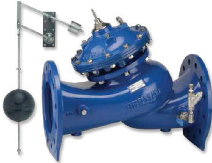
Modell 750-66-B nivåkontrollventil med totrinns vertikal flottør er en hydraulisk drevet, membranaktivert kontrollventil med to kammer. Ventilen er hydraulisk drevet og åpnes helt ved forhåndsinnstilt nedre nivå for magasinet, og stenges helt ved øvre nivå, uavhengig av ventildifferansetrykket.
